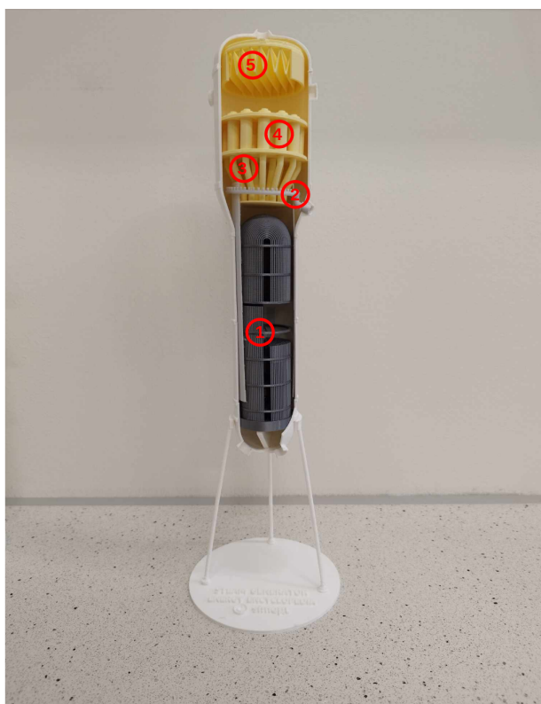
Rysunek 8: Model generatora pary. Skala 1:68.
