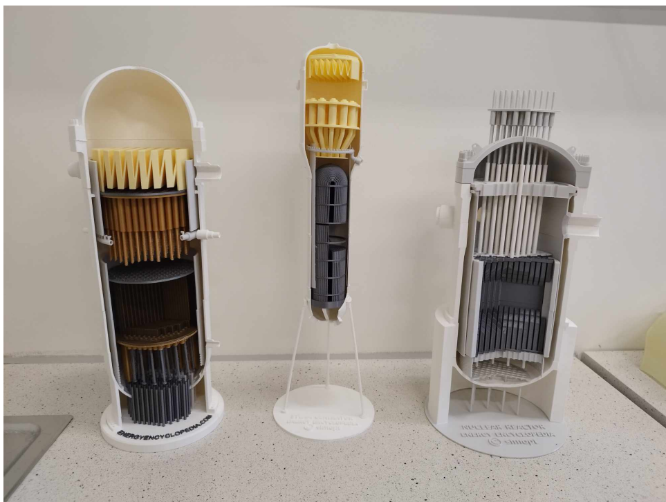
Rysunek 9: Wydrukowane modele. Od lewej: reaktor BWR, generator pary, reaktor PWR.
